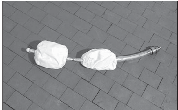
Doppelblase mit zusätzlicher Zwischenaumentspannung
