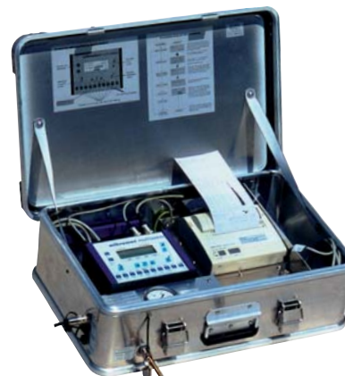
NetLog Alu-Prüfkoffer mit integriertem Drucker
