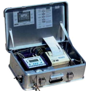
NetLog Alu-Prüfkoffer mit integriertem Drucker
