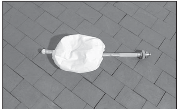
Einzelblase mit Vordruckmessung
